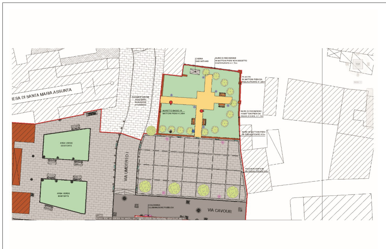
Figura 3. Estratto planimetrico di progetto. Sono rappresentate con retinature diverse le superfici a copertura, superficie a tetto verde, strade e piazzali, area a verde.
